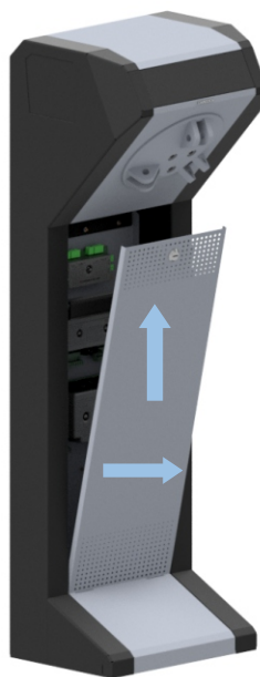
Рисунок 7.4.2 – Демонтаж центральной панели
