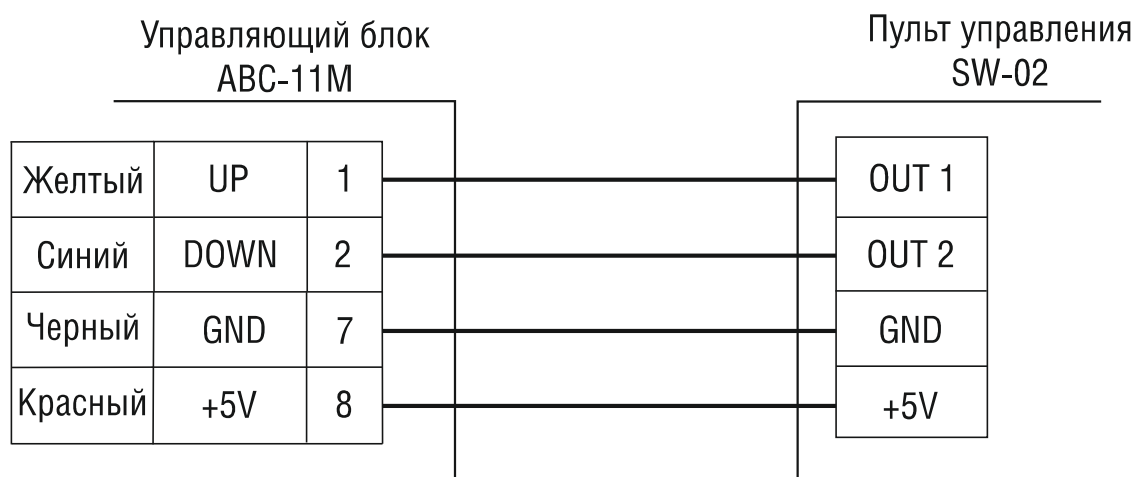
Рисунок 6.8.2 Схема подключения пульта дистанционного управления шлагбаумом «SW-02»
