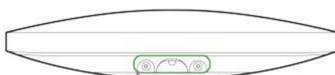
Не переворачивайте хаб при вертикальной фиксации (например, на стене).
