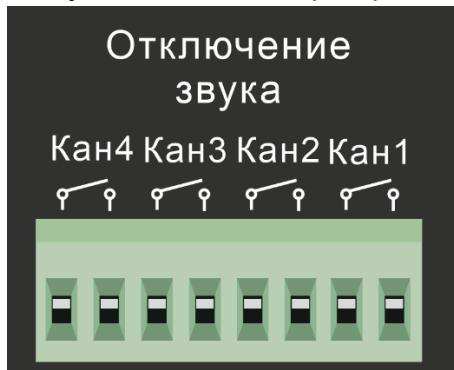
Рис.2.9. Входы отключения трансляции
