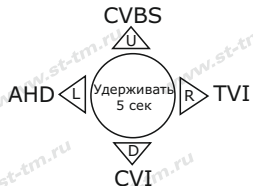
Рис.3 Схема переключения стандартов видеосигнала
