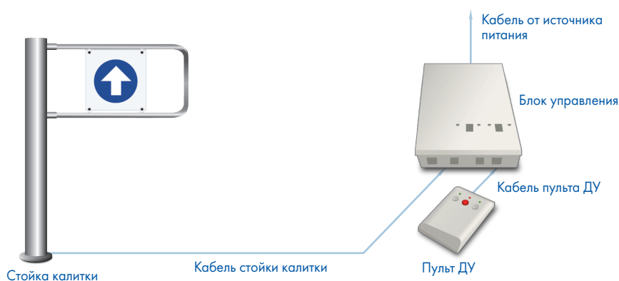
Схема подключения калитки PERCo-WMD-05S(SW)
