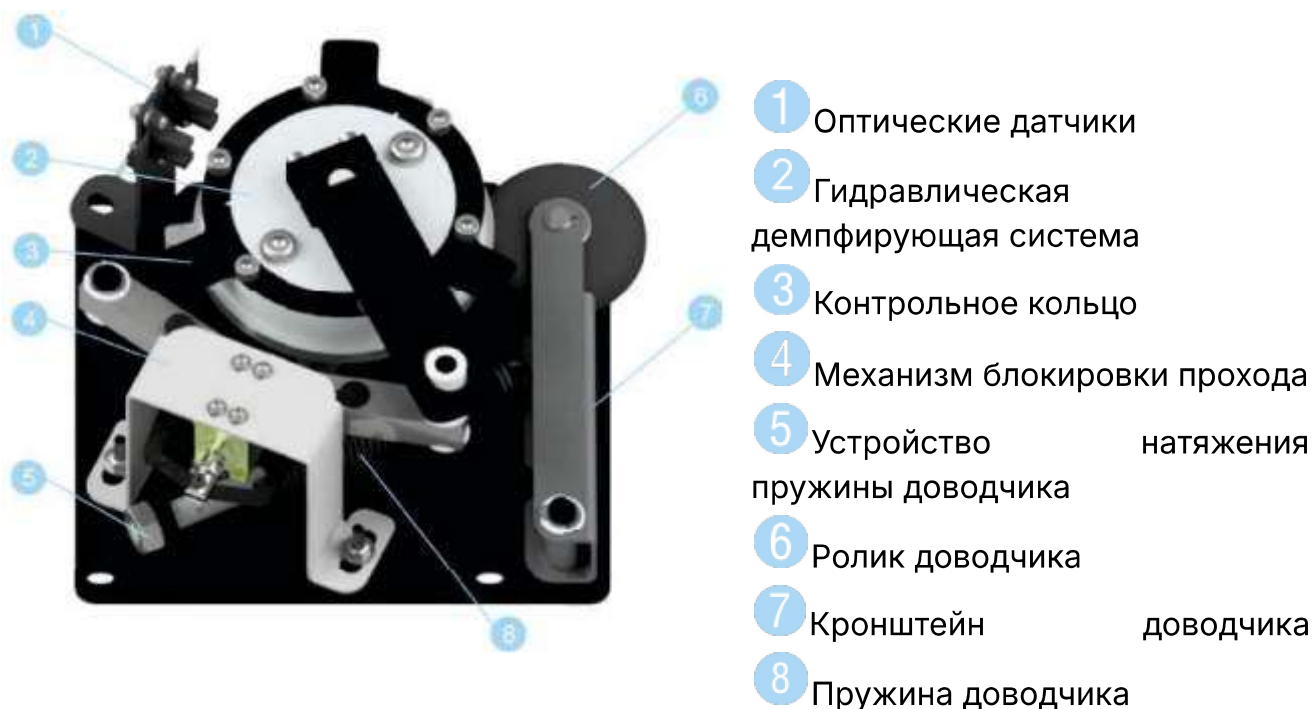
Рисунок 6.2.1. - Устройство механизма турникета
