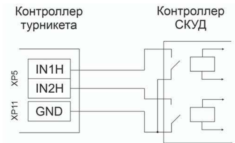
Рисунок 8.2.2 Схема подключения турникета к СКУД «сухой контакт»
