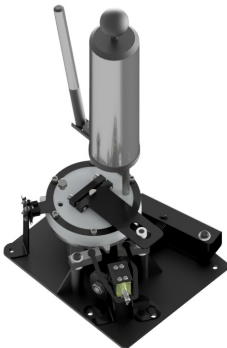
Рисунок 12.3.3 – Доливка демпферной жидкости
