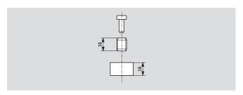
Удлинитель шпинделя TS 73 V / 83
