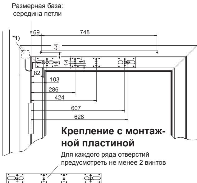
Шаблон для сверления DIN слева и DIN справа с зеркальным отражением
