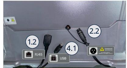
Интеграция с системой контроля доступа (СКУД)
