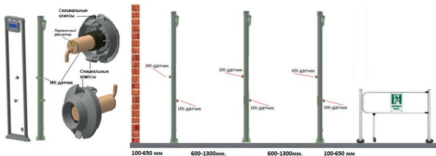
В крайней необходимости и после согласования со специалистом «БЛОКПОСТ», расстояние излучения от ИК-датчиков до светоотражателя возможно изменить, используя переменный резистор расположенного на обратной части ИК-датчика (только при наличии данного компонента).
