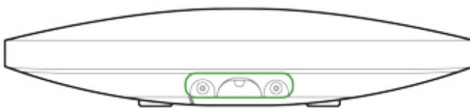
Не переворачивайте хаб при вертикальной фиксации (например, на стене). При правильной фиксации логотип Ajax будет читаться горизонтально.
