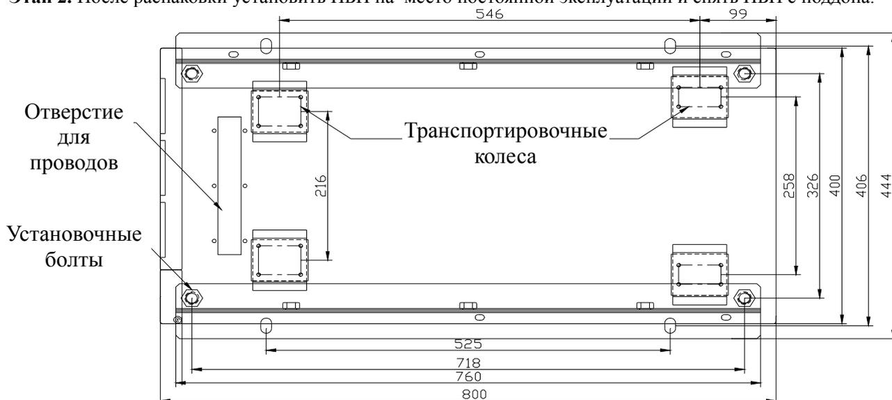
**Рис.5-3 Шасси корпуса ИБП Monolith XS**
