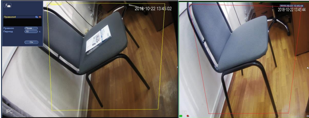
Рисунок 8.105 «Пропавший предмет» до и после срабатывания.
