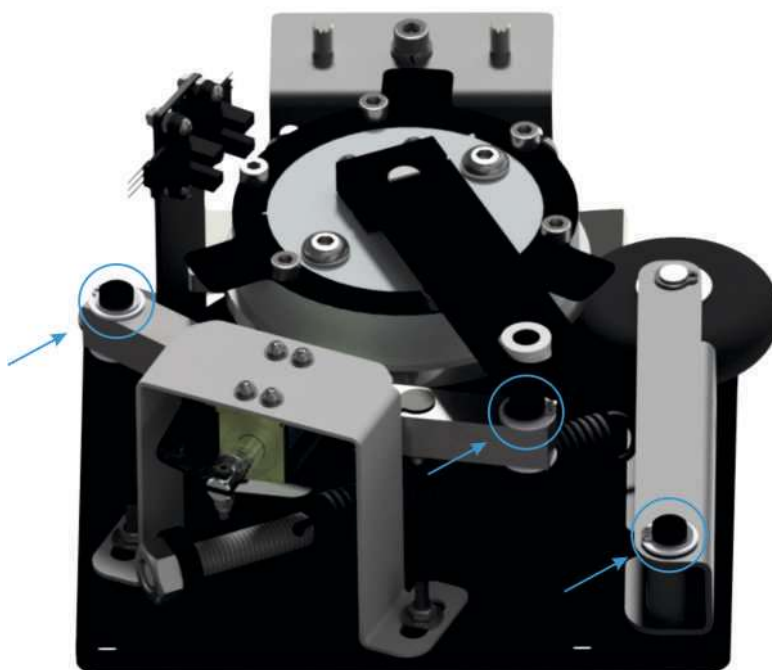
Рисунок 12.5.1 - Места смазки подвижных частей
