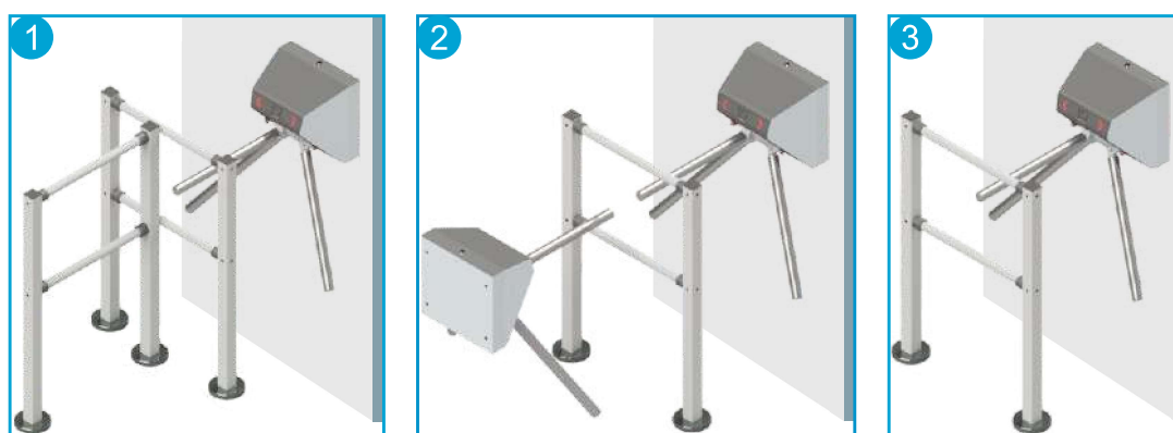
1 2 3 -турникет установлен правильно
