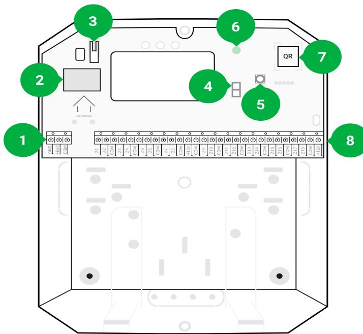
1. Клеммы питания пожарных датчиков
