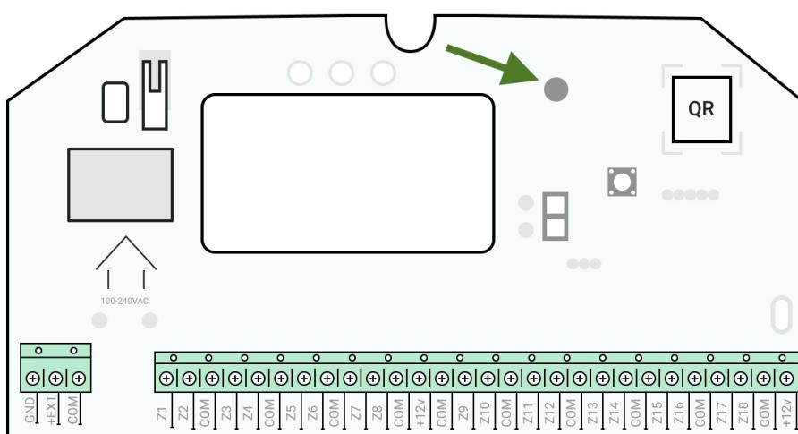
Световой индикатор MultiTransmitter может гореть белым, красным или зеленым цветом, в зависимости от состояния устройства. Учитывайте,
