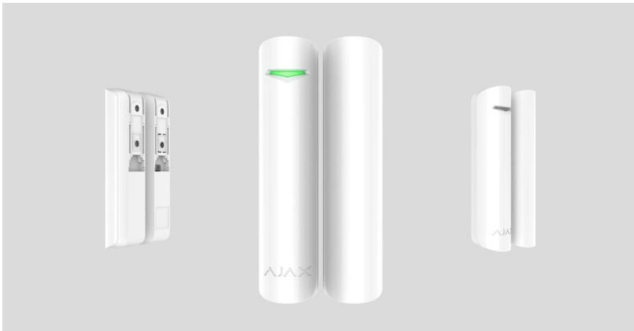
**DoorProtect Plus** — беспроводное охранное устройство, определяющее открытие, удары и наклоны, с разъемом для подключения внешнего проводного датчика. Используется внутри помещений. К системе безопасности Ajax подключается по защищенному протоколу [Jeweller](#), дальность связи — до 1200 метров при отсутствии преград. Работает до 5 лет от комплектной батареи и обрабатывает более миллиона открытий.
