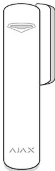
При установке датчика на перпендикулярных плоскостях (внутри коробки / рамы), используйте малый магнит из комплекта. Расстояние между магнитом и датчиком не должно превышать 1 см.
