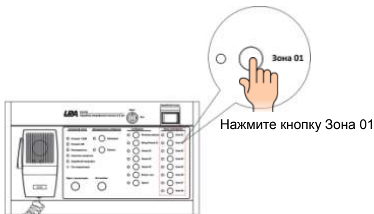
Рис. 4.1. Выбор зоны оповещения на микрофонной консоли LPA-EVA-FM
