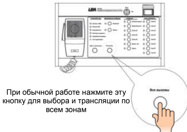
Рис. 4.4. Выбор всех зон оповещения на микрофонной консоли LPA-EVA-FM
