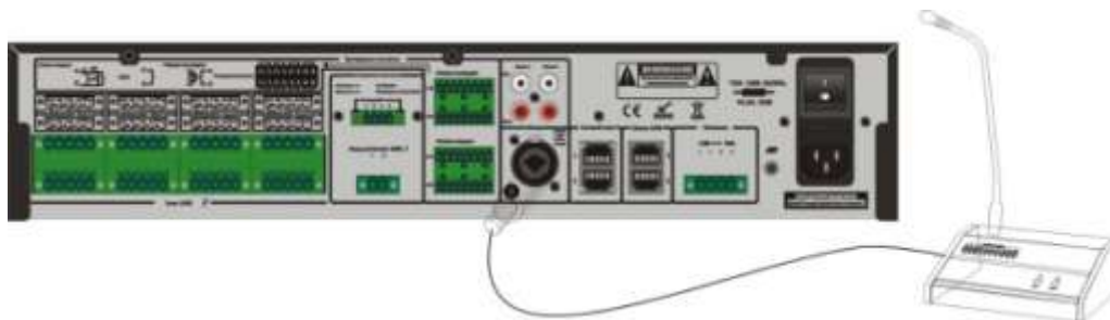
Рис. 4.3. Схема подключения основного микрофона к разъёму «Микр. 2» на задней панели усилителя мощности LPA-EVA-8500
