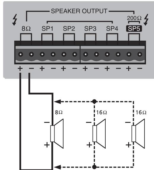
При использовании трансляционных громкоговорителей соблюдайте полярность. В линия формируется с помощью выходного согласующего трансформатора.
