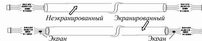
Рис. 4 Неэкранированный ( L \leq 28 м, Кабель 4 \times 0,2 мм 2 ; L \leq 50 м, Кабель 4 \times 0,3 мм 2 ) Экранированный ( L \leq 80 м, Кабель 4 \times 0,5 мм 2 )
