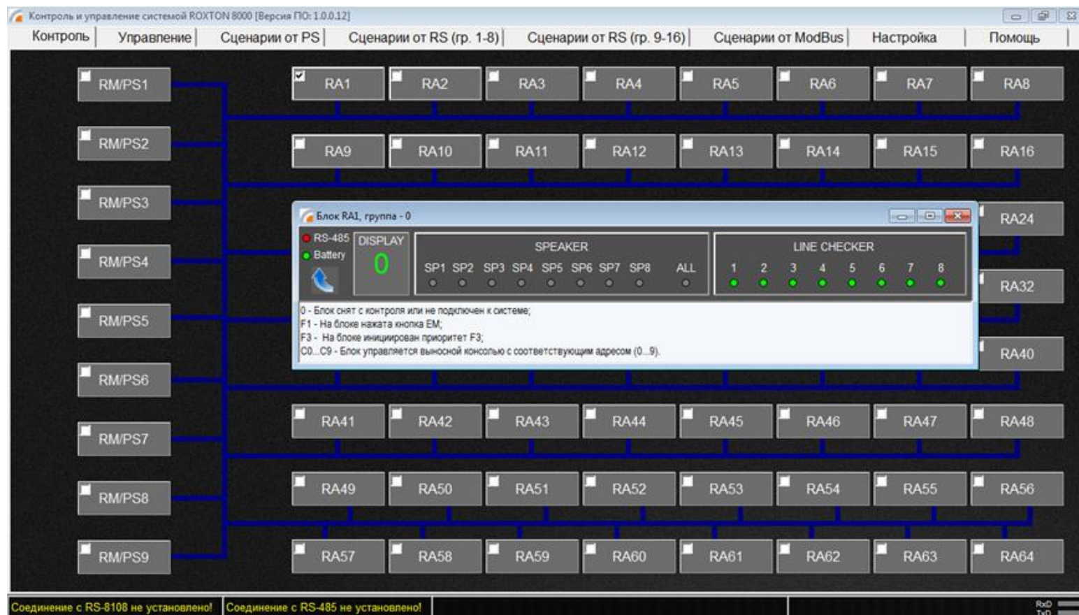
Внешний вид окна состояния исполнительного блока.
