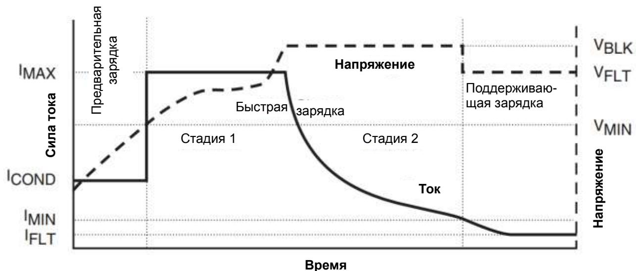
Рис. 4.2. График работы зарядного устройства LPA-EVA-BC с аккумуляторами
