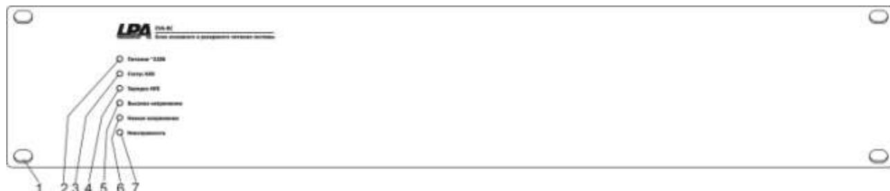
Рис. 3.2. Лицевая панель резервного источника питания и зарядного устройства LPA-EVA-BC
