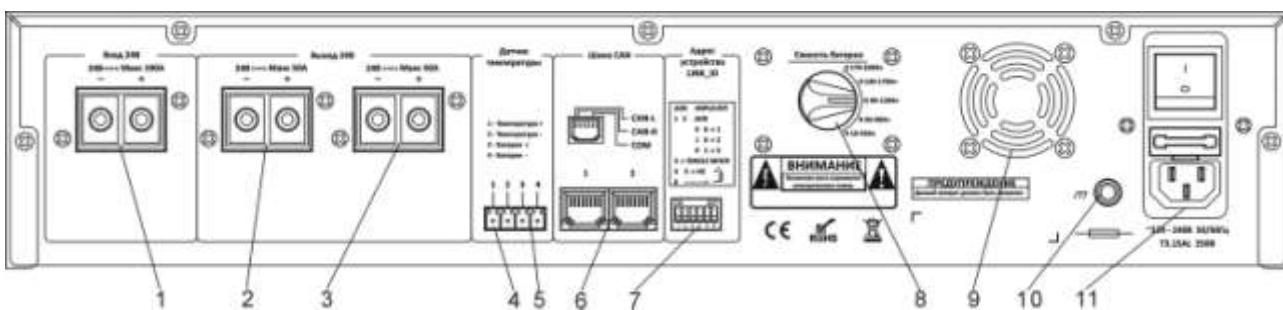
Рис. 3.3. Задняя панель резервного источника питания и зарядного устройства LPA-EVA-BC
