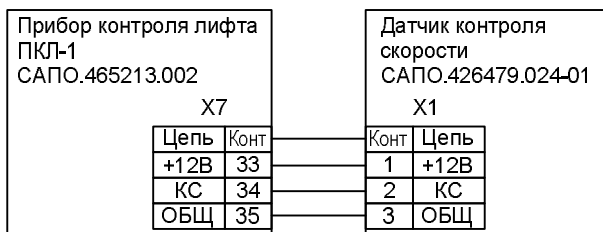
Рис. 2 Схема подключения датчика контроля скорости к прибору контроля лифта ПКЛ-1
