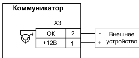
Рис.4 Схема подключения внешнего устройства к коммуникатору
