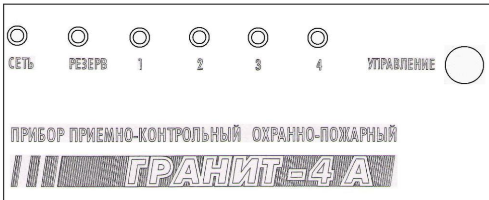
Рис.2 Внешний вид панели индикации и управления прибора на примере Гранит-4А
