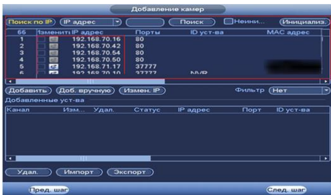
Рисунок 6.10 Настройка добавления камер по поиску в сети.
