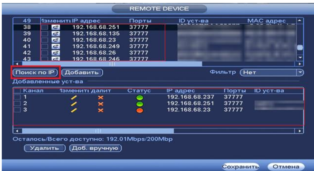
Рисунок 7.32 Настройка добавления камер по поиску в сети.
