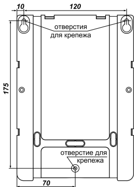
Рис.1 Основание. Присоединительные размеры
