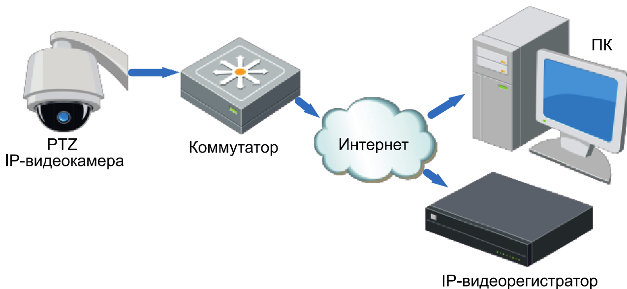
Рис. 3.1. Доступ к IP-видеокамере через локальную сеть
