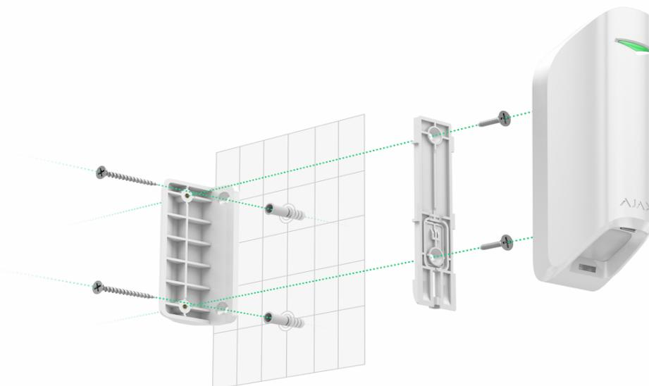
**Процесс монтажа датчика:**
