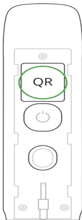
3. Включите устройство, зажав кнопку включения на 3 секунды.
