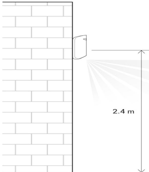
Установка датчика не на рекомендуемой высоте сокращает площадь зоны обнаружения и может оказаться на качестве детектирования движения.
