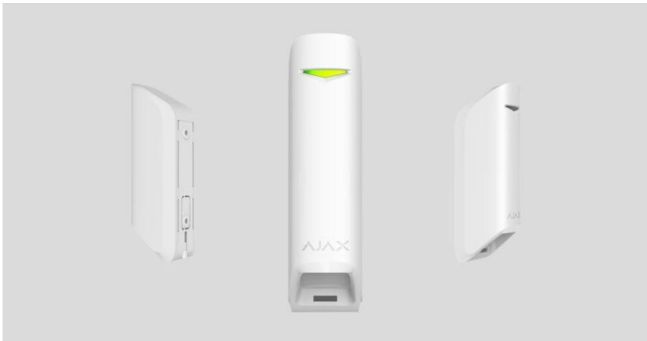
**MotionProtect Curtain** – беспроводной датчик движения типа «штора». Датчик имеет узкий горизонтальный угол обзора и предназначен для контроля периметра внутри помещения: защиты окон, дверных проемов и других входов/выходов на охраняемом объекте. Распознает движение на расстоянии до 15 метров.
