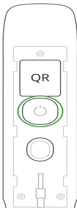
Чтобы произошло обнаружение и сопряжение, устройство должно находиться в зоне действия радиосвязи хаба (на одном охраняемом объекте). Запрос на подключение к хабу передается только в момент включения устройства.
