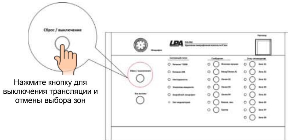
Рис. 4.3. Прекращение трансляции и отмена выбора зон на микрофонной консоли LPA-EVA-RM
