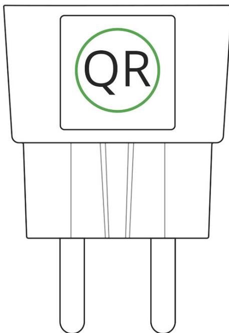
3. Подключите Socket к розетке и подождите 30 секунд — светодиодная рамка замигает зеленым.
