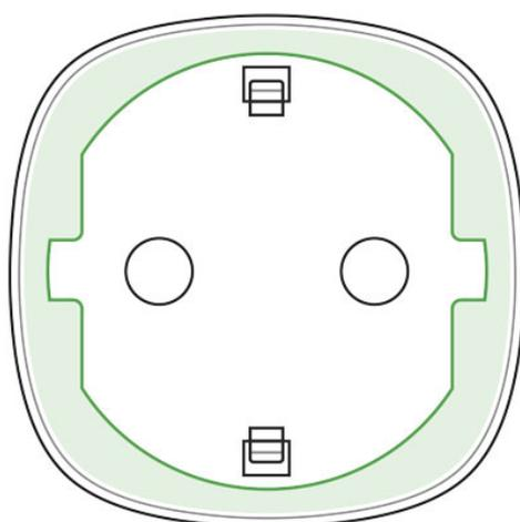
Socket информирует об уровне потребляемой подключенными приборами мощности светодиодной рамкой.
