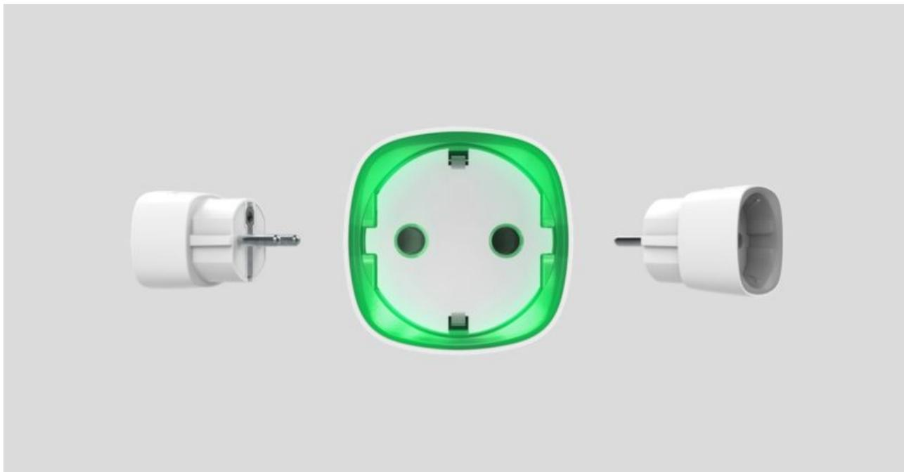
**Socket** — радиоуправляемая умная розетка для помещений со счетчиком энергопотребления. Исполнена в виде переходника розетка-вилка европейского типа (Schuko type F), управляющая питанием приборов и рассчитанная на нагрузку до 2,5 кВт. Снабжена защитой от перегрузки и индикацией уровня нагрузки. К системе безопасности Ajax устройство подключается по защищенному протоколу [Jeweller](#), дальность связи — до 1000 метров при отсутствии преград.
