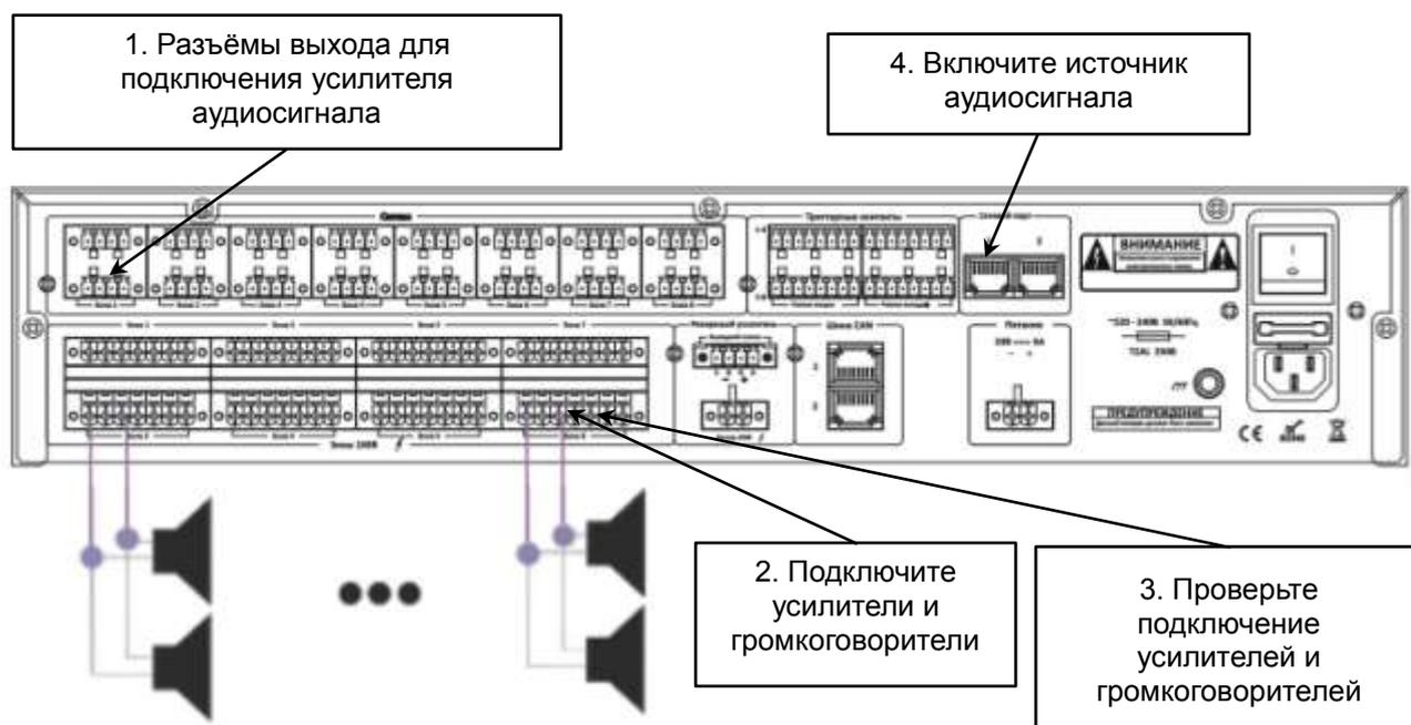
Рис. 4.2. Сетевое управление выходами коммутатора усилителей LPA-EVA-MS
