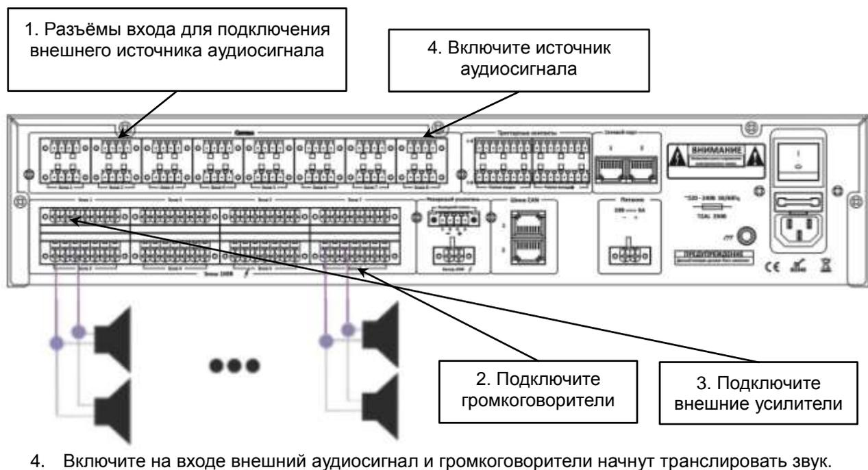
Рис. 4.1. Управление местными входами коммутатора усилителей LPA-EVA-MS
