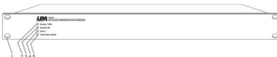
Рис. 3.2. Лицевая панель блока записи сообщений LPA-EVA-RC
