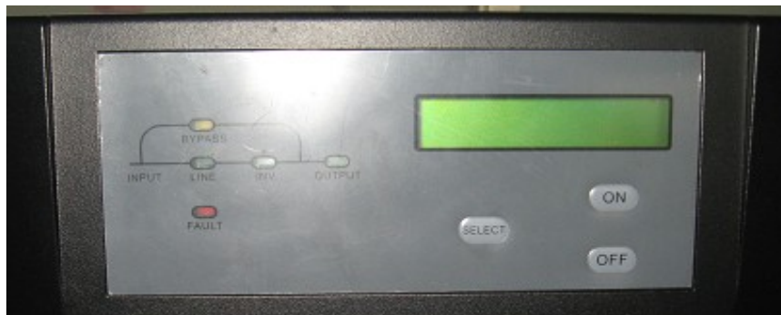
Рис. 3.3-1 Внешний вид лицевой панели ИБП INELT серии Monolith K 6k-10k
